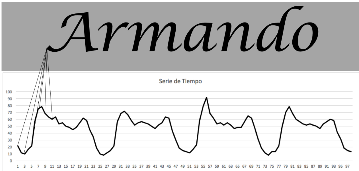
Figura 4.6: Imagen a serie de tiempo por Escaneo Lineal.
