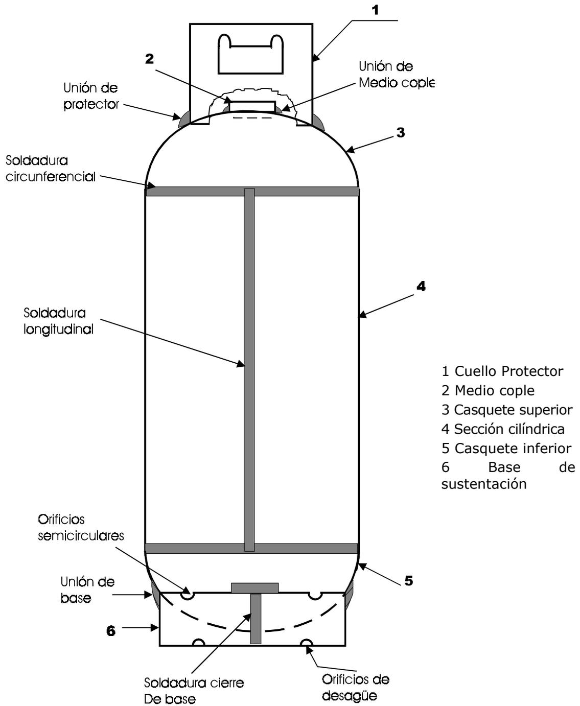
**Figura 1: Recipiente portátil para Gas L.P. tipo A**
