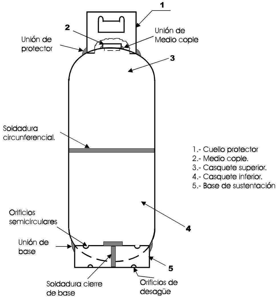
**Figura 2: Recipiente portátil para Gas L.P. tipo B**
